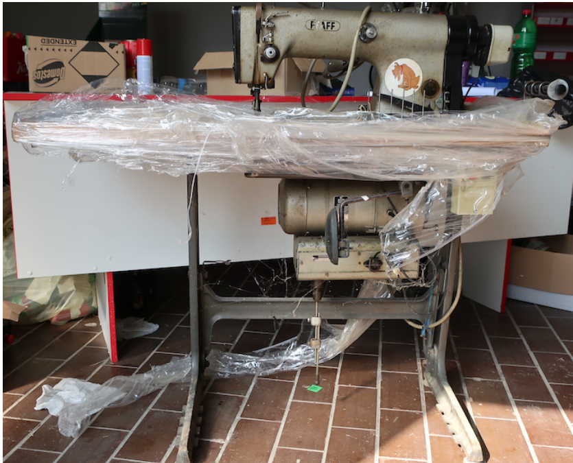
Broj 8. Stroj za spajanje gornjeg i donjeg dijela cipele, proizveden 1997. god.
