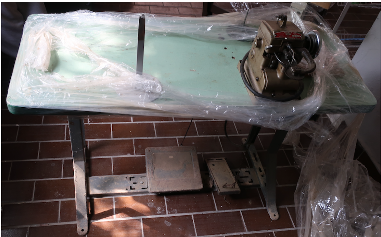
Broj 8. Stroj za spajanje gornjeg i donjeg dijela cipele, proizveden 1997. god.
