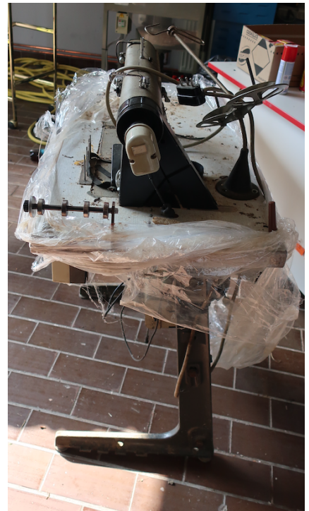
Broj 8. Stroj za spajanje gornjeg i donjeg dijela cipele, proizveden 1997. god.
