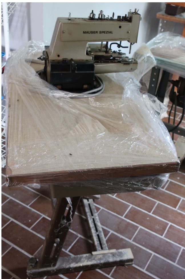
Broj 5. Stroj za šivanje dugmadi; MAUSER, proizveden 1998. god.
